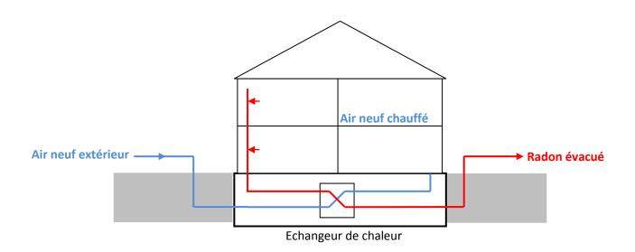
L'appareil de ventilation avec récupération de la chaleur peut être installé dans une partie éloigné du bâtiment, par exemple une cave ou un débarras. Les bouches de pulsion d'air doivent être à bonne distance des points d'extraction de l'air intérieur, en positionnant l'extraction de l'air chargé en radon dans le sous-sol ou au niveau le plus bas du bâtiment. Un tel système est généralement rentable lorsqu'il existe une différence de température importante entre l'extérieur et l'intérieur.
