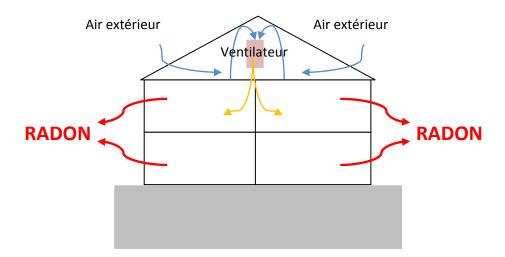
Il faut ventiler le niveau le plus bas du bâtiment, et ventiler tous les niveaux dès que les conditions extérieures le permettent. L'air doit être pulsé et doit pouvoir sortir par les fenêtres ou les orifices d'aération sur les murs adjacents ou opposés. Il est également possible de faire passer l'air par un système de chauffage central existant.
