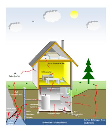
Le radon diffuse dans une construction par les fissures et les perforations de la dalle
