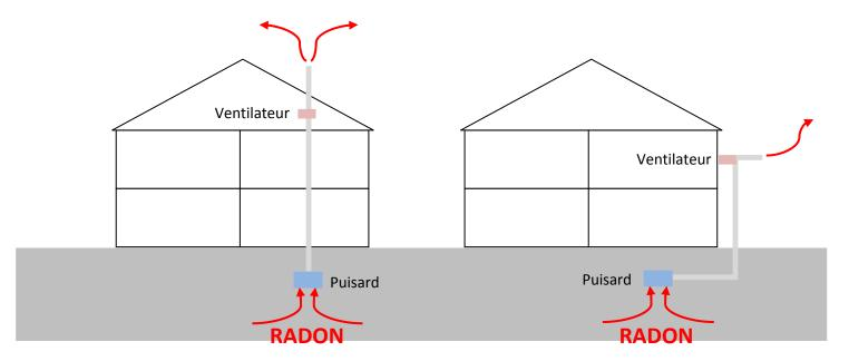
Lorsque la perméabilité sous la dalle n'est pas très bonne, il est encore possible d'avoir recours à cette méthode. En cas de perméabilité trop faible, il pourra être nécessaire d'utiliser un grand nombre de tuyaux (drains) d'aspiration. Cette méthode nécessite l'intervention de professionnels.
